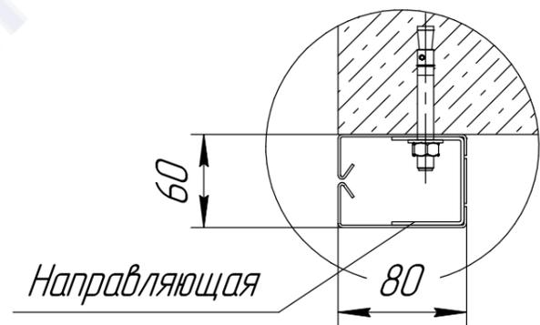
Вес шторы приходится на две боковые крышки, расположенные слева и справа. Для конструкций шире 3-х метров предусматривается установка дополнительных кронштейнов для обеспечения жесткости короба. Вес погонного метра короба составляет 30 кг, вес погонного метра направляющих шин 5 кг. К месту расположения блока управления подвести:
