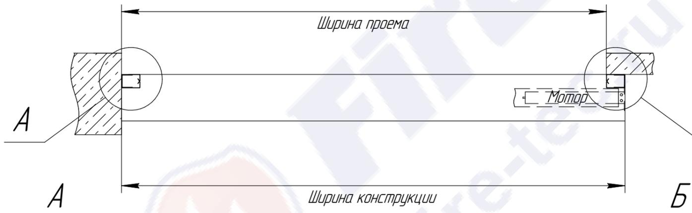
Вес шторы приходится на две боковые крышки, расположенные слева и справа. Для конструкций шире 3-х метров предусматривается установка дополнительных кронштейнов для обеспечения жесткости короба. Вес погонного метра короба составляет 30 кг, вес погонного метра направляющих шин 5 кг.
