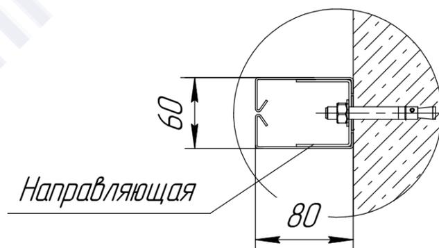
Вес шторы приходится на две боковые крышки, расположенные слева и справа. Для конструкций шире 3-х метров предусматривается установка дополнительных кронштейнов для обеспечения жесткости короба. Вес погонного метра короба составляет 30 кг, вес погонного метра направляющих шин 5 кг. К месту расположения блока управления подвести:
